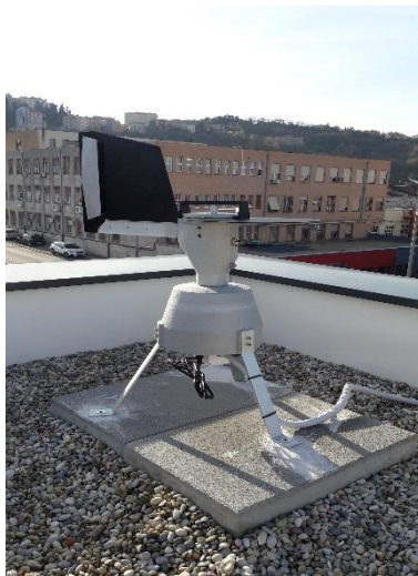
Slika 2. Aparat za uzorkovanje peludi
